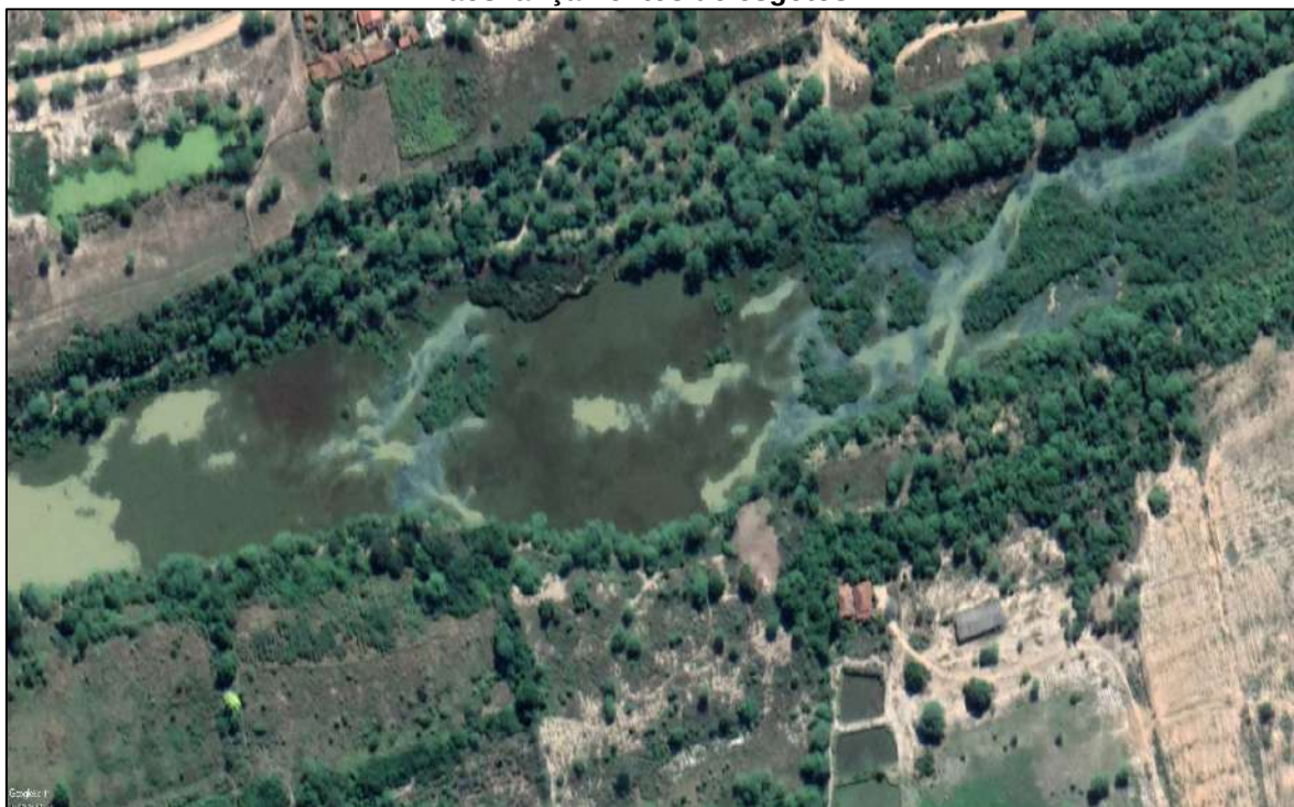
Figura 86 - Trecho do rio de Contas na zona urbana em processo de eutrofização devido aos lançamentos de esgotos
